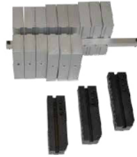
Genleşme seti OD 355mm (14")' ye kadar (3 çelik alet tutucu ve çeneler 7, 8, 9, 10, 11 dahil) Boru malzeme kalınlığı 7mm (0.26") kadar olması tavsiye edilir.
